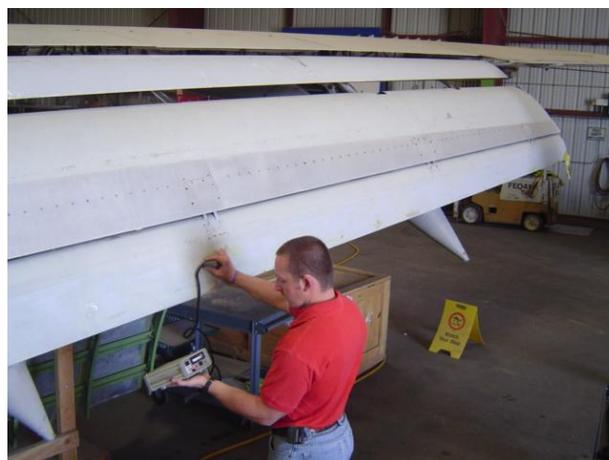
**Figura 3 – Mantenimiento: búsqueda de fisuras en superficie de control de materiales compuestos.**
