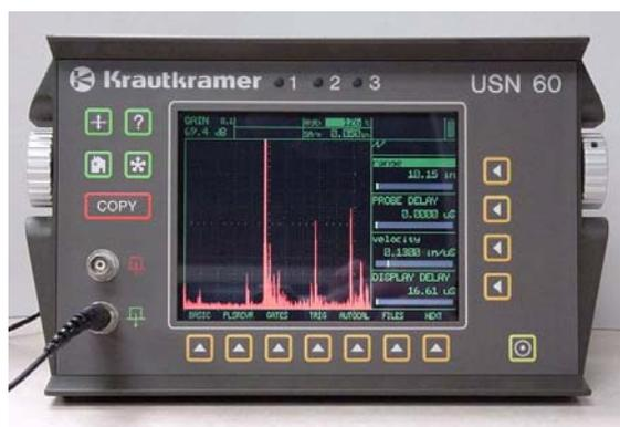
**Figura 50 – Equipos con osciloscopios incorporados**
