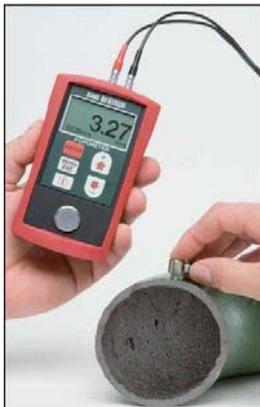
**Figura 1 – Medición de espesor en tuberías.**
