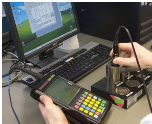
**Figura 54 – Calibración del instrumento.**
