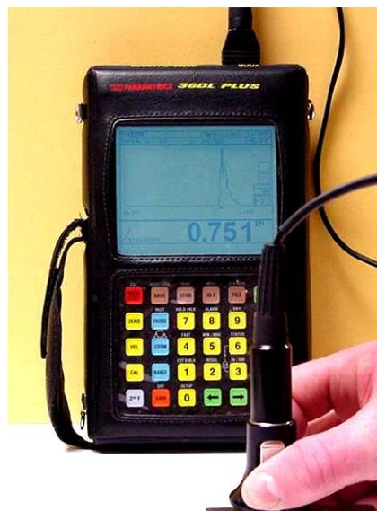
**Figura 49 – Equipos portátiles de medición de espesores**
