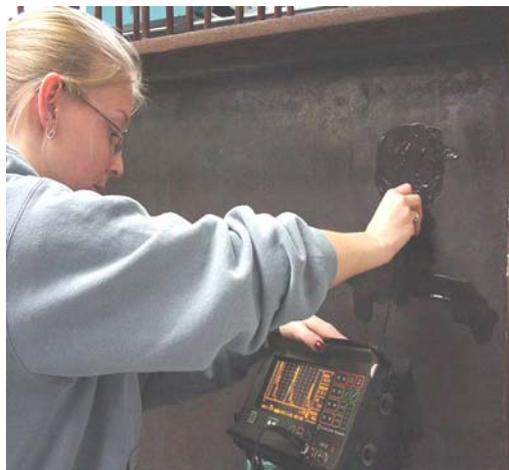
**Figura 48 – Detección de delaminación en materiales compuestos.**
