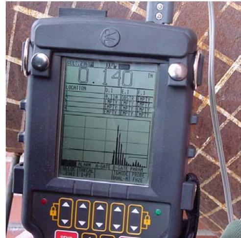
**Figura 47 – Medición de espesores.**
