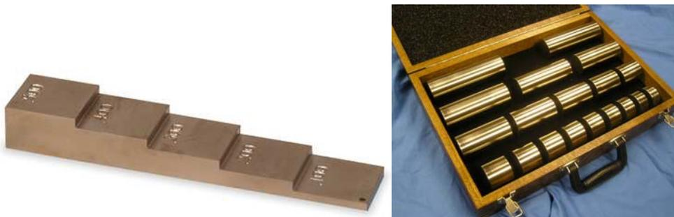
**Figura 53 – Patrón de medición de espesores.**
