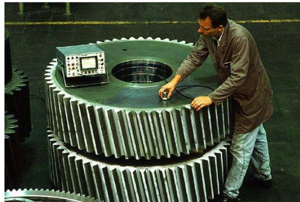
**Figura 2 – Búsqueda de fisuras en control de calidad de engranajes.**
