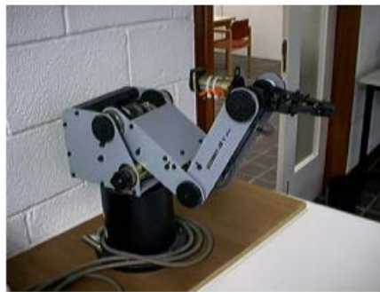
Figura 1. Fotografía del manipulador SCORBOT ER-VPlus en la que se observan los distintos elementos que componen la estructura mecánica y las articulaciones que las unen.
